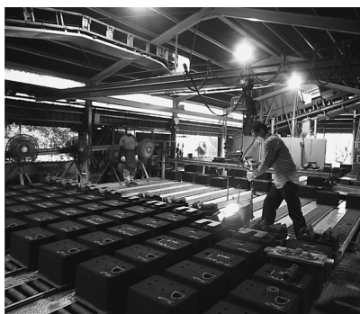
高温の輻射熱と格闘しながら、溶解した金属を型に流し込む。
