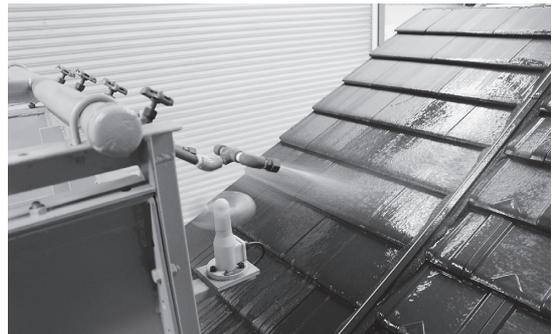
雨水の浸透・漏れ試験
