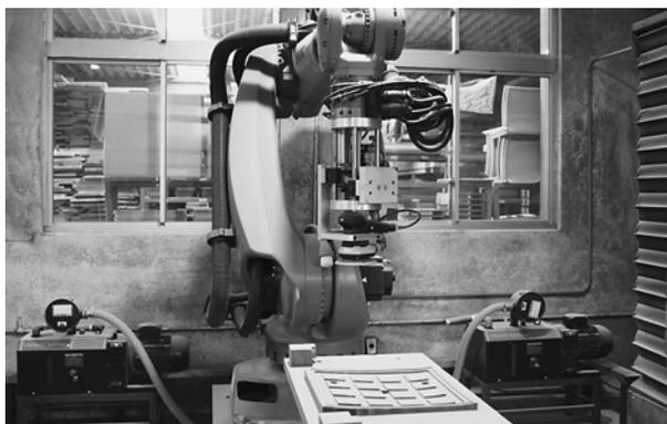
KUKA 6軸多関節ロボットの導入（平成25年度）
