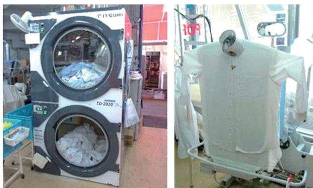
導入設備：二段式乾燥機（左）、ボディプレス
