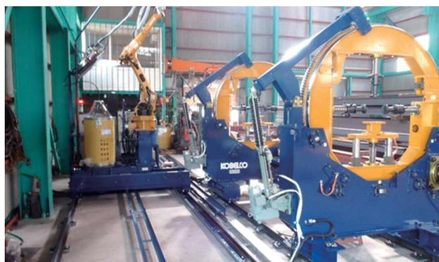
導入設備：柱大組立溶接ロボットシステム
