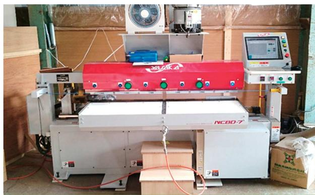
導入設備：PNC ボーリング・ダボ打ち機
