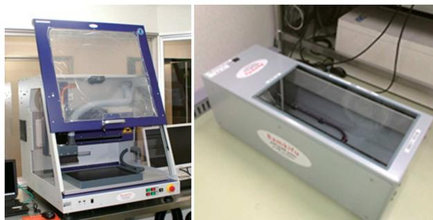
導入設備：インソール切削機(左)、足型レーザースキャナ
