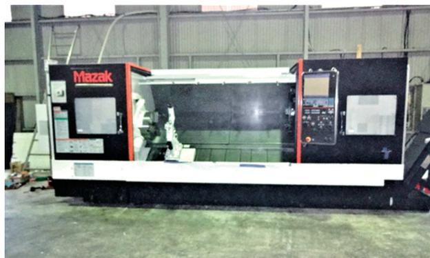
導入設備：複合 CNC 旋盤
