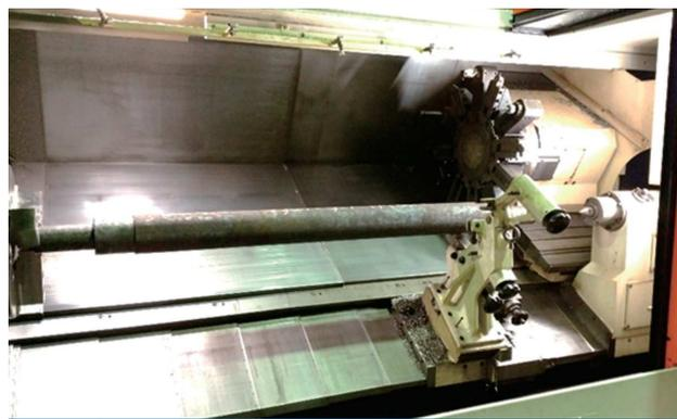
導入設備：複合 CNC 旋盤（加工部）
