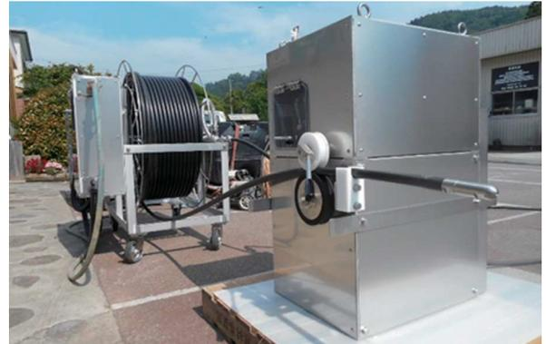
設備機械：排水管エア洗浄システム
