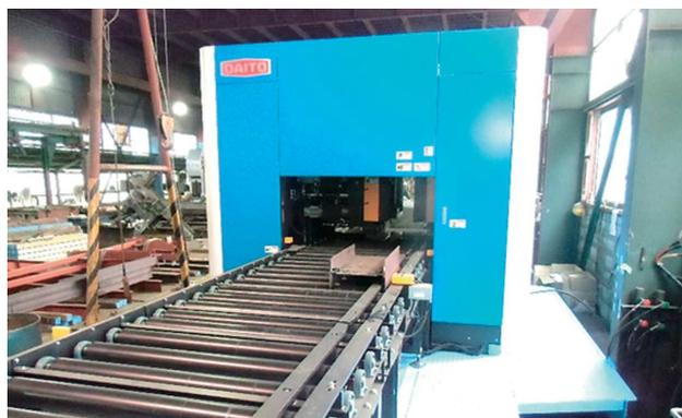
導入機：H型鋼自動開先加工機
