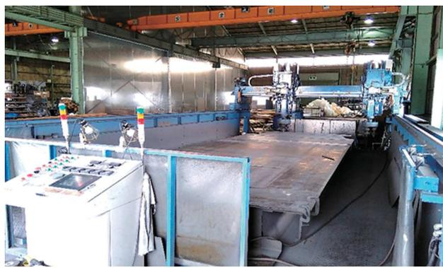
ステンレス鋼板の湿式研磨装置
