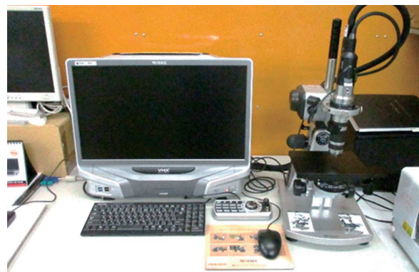
導入設備：3次元画像検査機
