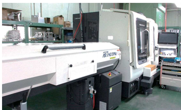
導入設備：NC 旋盤とバーフィーダー
