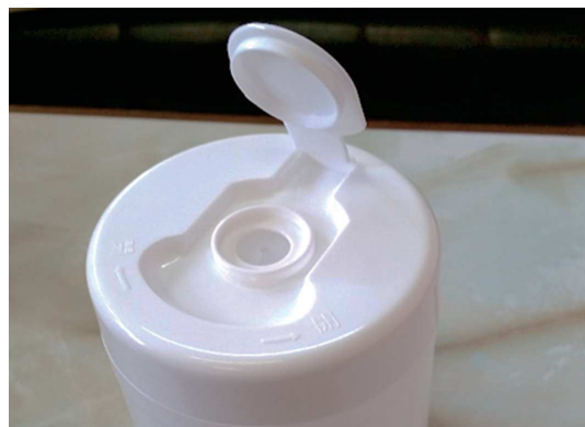
加工した金型による成形品
