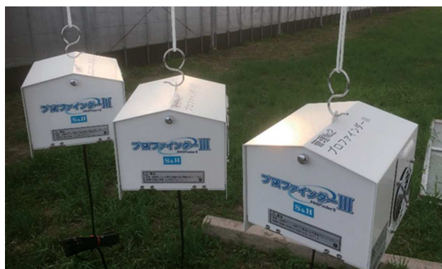
導入設備：ハウス内環境測定器
