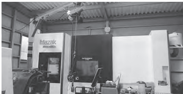
複合加工機 Mazak INTEGREX J-300
