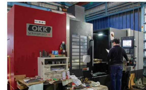
▲高精度同時5軸加工機
