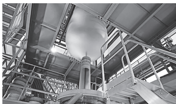
インフレーションフィルム成形機の一つ
