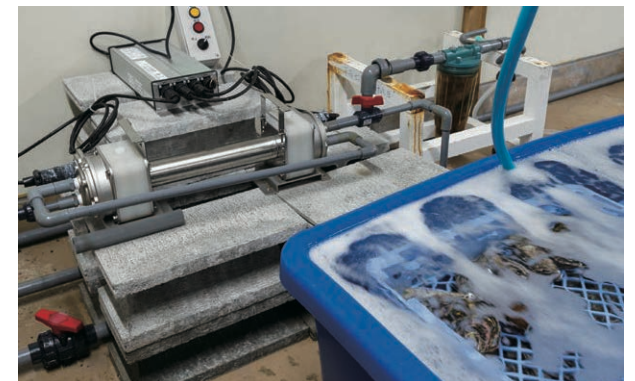
▲UV-LED流水殺菌装置が出荷の際の浄化処理の低コスト化を実現
