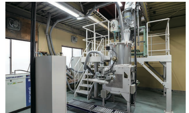
▲粉体計量器(1階)が原料の投入・混合・計量を自動で行う
