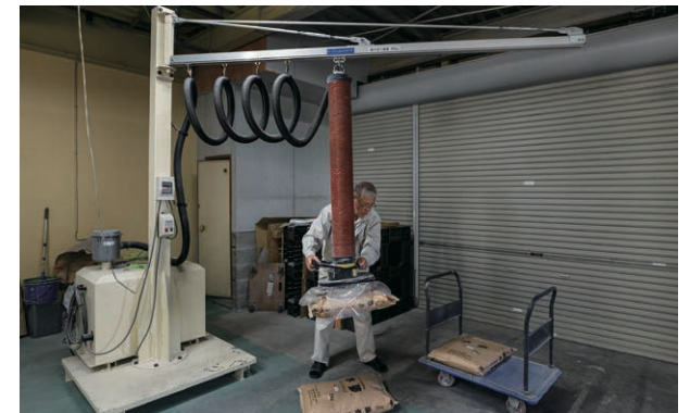
▲真空ポンプで吸着と持ち上げをこなすランサー設備(1階)
