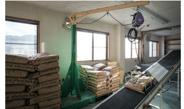
▲玄米キャッチャー(2階)で原料25kgを持ち上げ、次の工程へ
