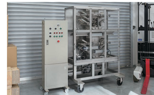
▲粉体や顆粒中の異物を除去する超高磁力棒マグネット除鉄装置
