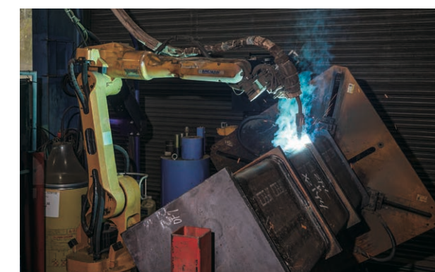
▲鉄骨の構造上重要な部分の溶接を担うロボット
