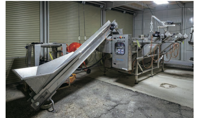
▲出荷前の牡蠣を連続的に省力で選別する専用サイズ選別機
