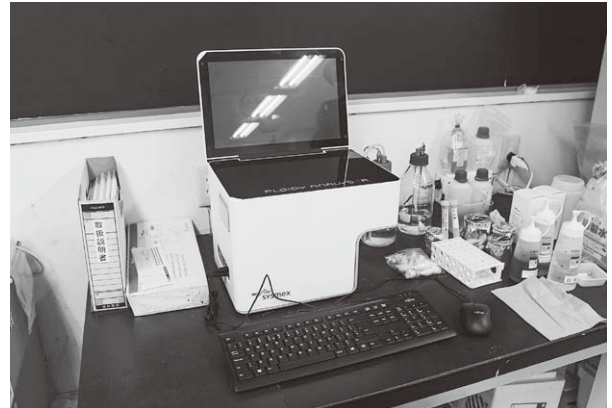
プロイディアナライザー (倍数性決定やゲノムサイズ解析に使用)
