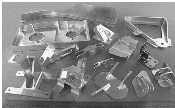
航空機部品の例(アルミブロックから削り出して作る)
