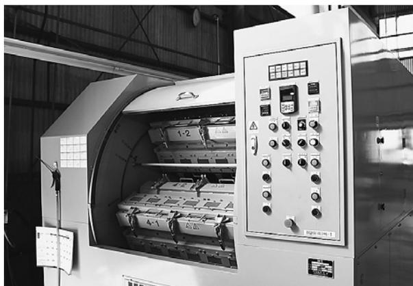
仕上げ作業の自動化が図れる多層式遠心バレル研磨機
